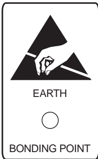
Punto di collegamento a terra
